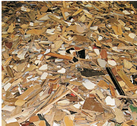
Sperrabfallaufbereitung Sekundärbrennstoff Altholz
