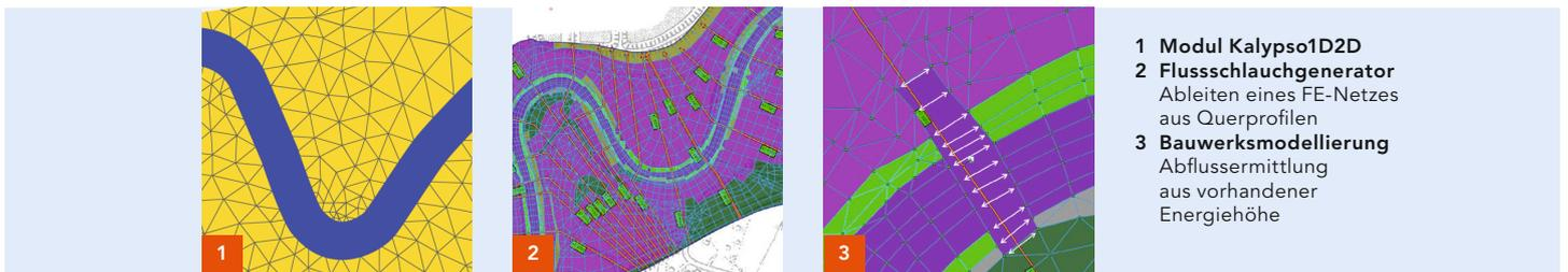
Kalypso1D2D vereint verschiedene hydrodynamische Rechenmodelle unter einer einheitlichen Benutzeroberfläche und steuert diese mit nahezu identischen Eingangsdaten an. Grundlage des Modellaufbaus ist das unstrukturierte Berechnungsnetz, welches 3- und 4-Eckelemente, 1D-Stränge sowie Definitionen von Bauwerken und Randbedingungen unterstützt.
